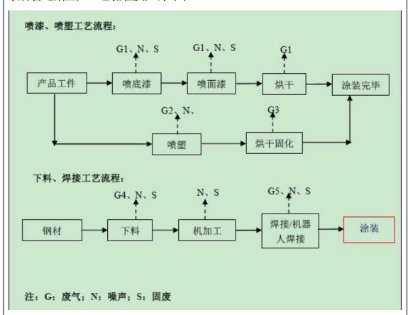
图 2 工艺流程图
