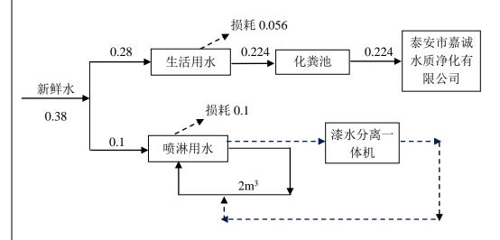
图 2-1 本项目水平衡图(单位: m³/d)
